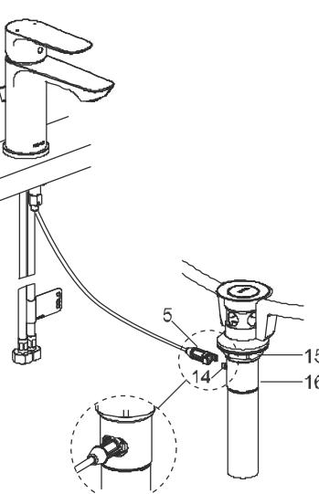
将提拉线缆末端(5)与线缆排水器的磁扣接头(14)相连接，并确保卡扣扣紧。
